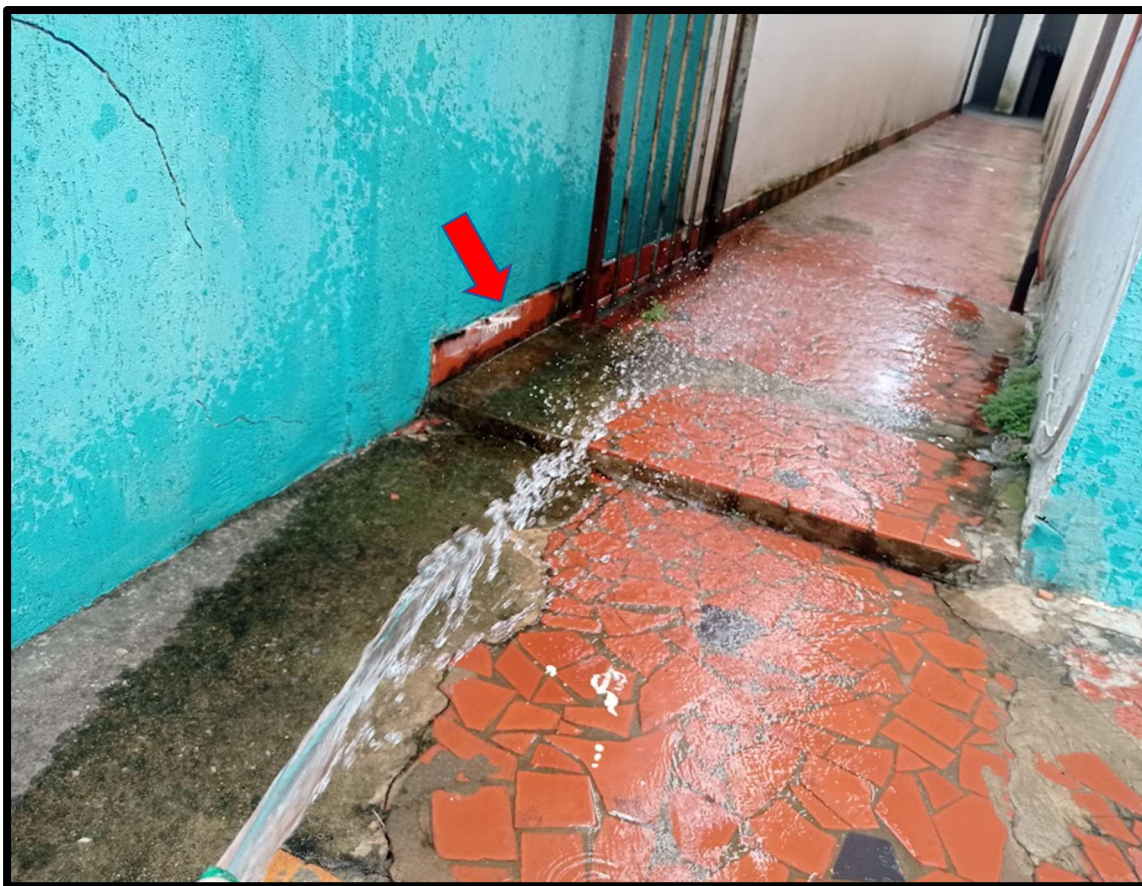
Figura 32 – Realizado teste hidráulico, criando uma lamina d água, durante periodo de 45 minutos.
