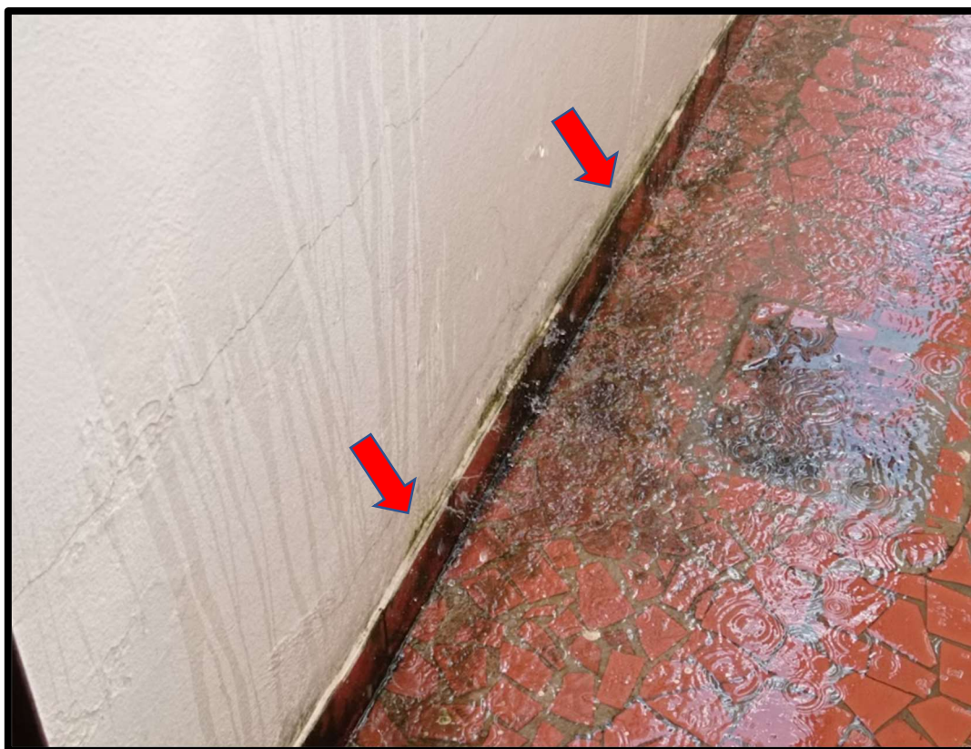
Figura 35 – Vista de outro ângulo do teste hidráulico, criando uma lamina d'água, durante período de 45 minutos.
