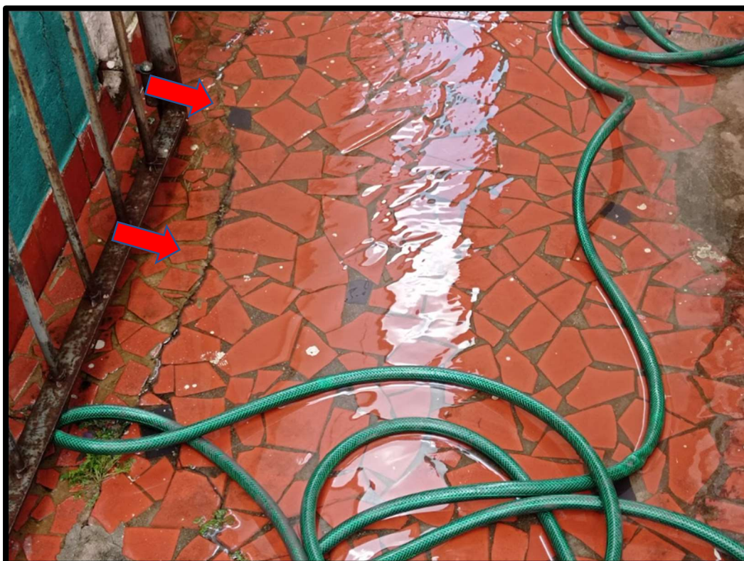
Figura 34 – Vista de outro ângulo do teste hidráulico, criando uma lamina d'água, durante período de 45 minutos.
