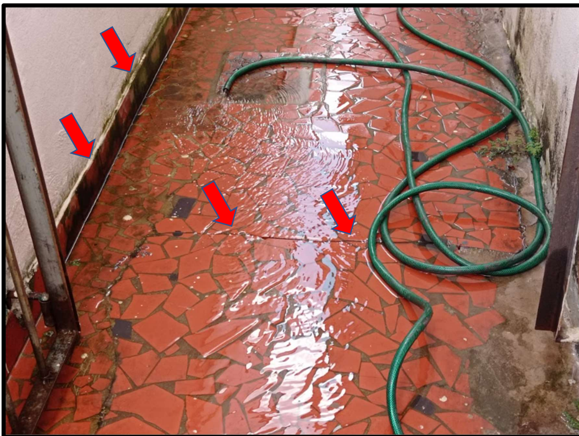
Figura 33 – Vista de outro ângulo do teste hidráulico, criando uma lamina d´água, durante periodo de 45 minutos.
